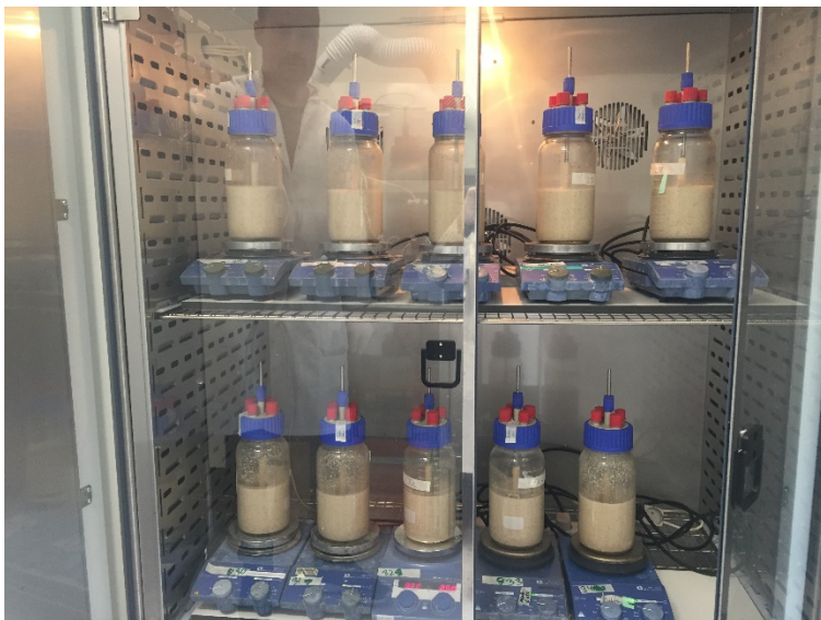
Foto 2. Fermenteringsbeholdere anvendt i laboratorieforsøget (Foto: Nuria Canibe).
